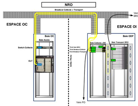
L'Opérateur Commercial indiquera à l'Opérateur de Réseau le numéro du port qu'il souhaite activer (n° de tiroir, n° de connecteur) correspondant au pré-câblage réalisé (les connecteurs étant repérés).
