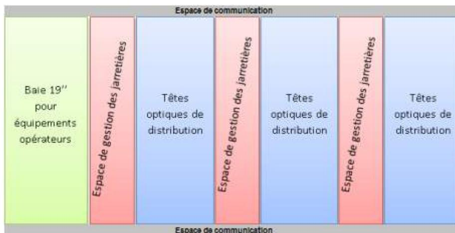
La configuration de base de ces SRO/PM est spécifique et est constitué des plusieurs modules communiquant entre eux, comprenant:
